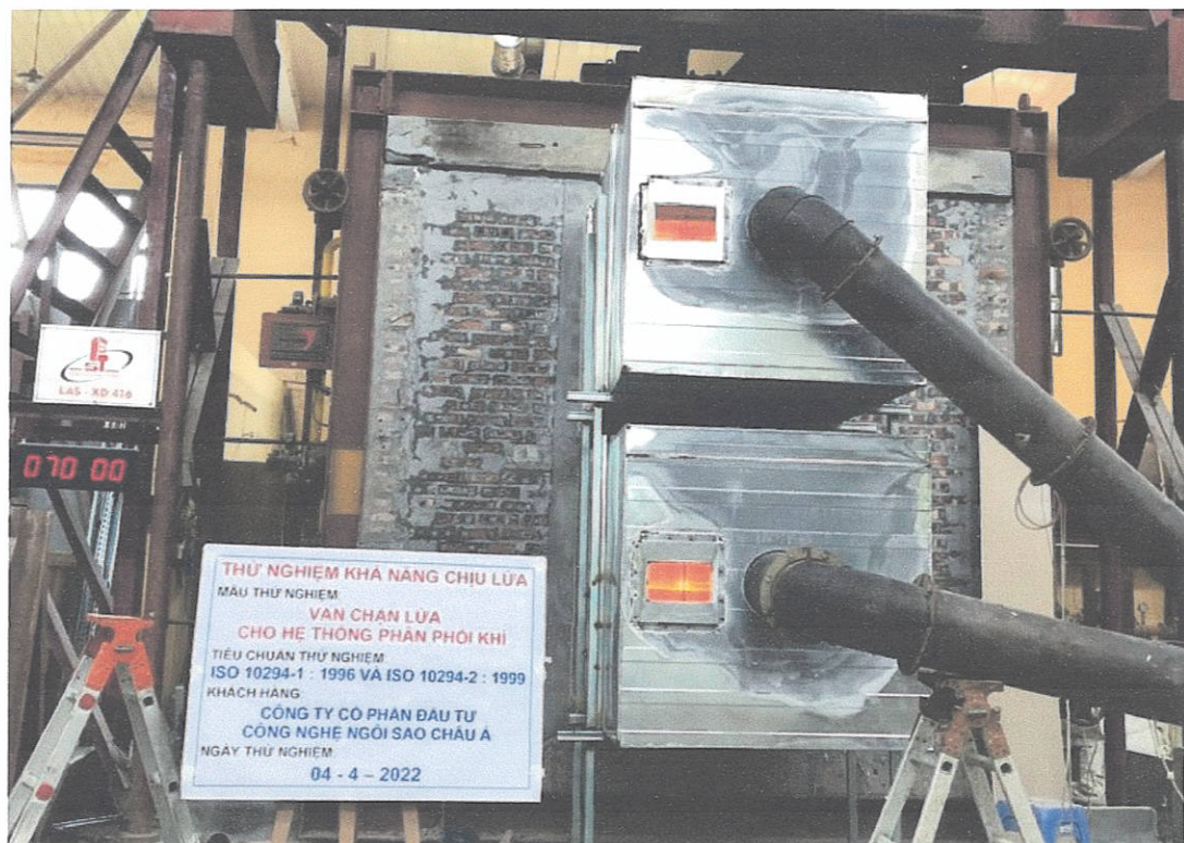
Ảnh D.12: Mẫu thử tại phút thứ 70 của quá trình thử nghiệm
