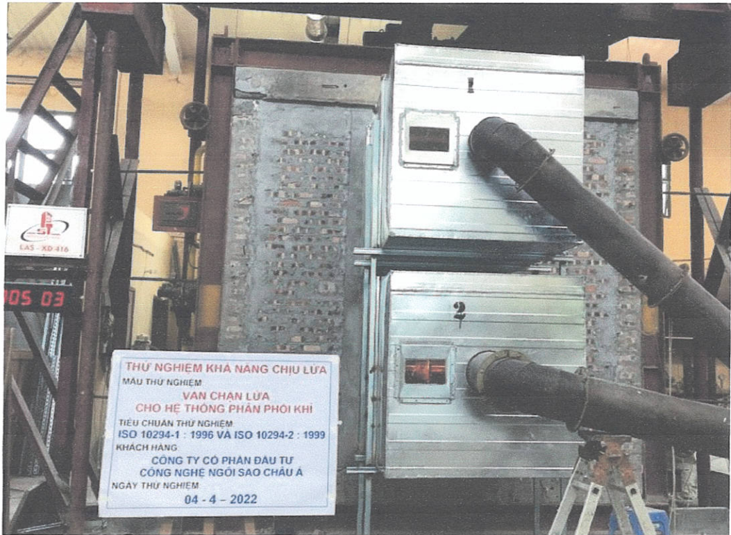
Ảnh D.5: Mẫu thử tại phút thứ 06 của quá trình thử nghiệm
