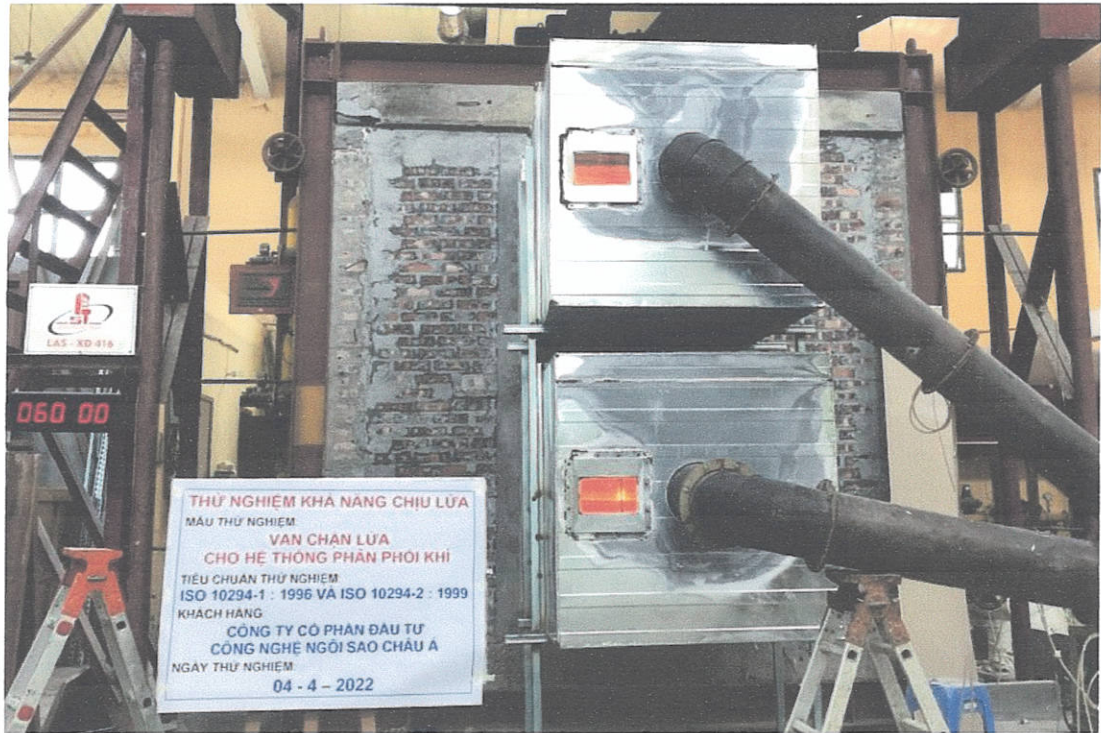
Ảnh D.11: Mẫu thử tại phút thứ 60 của quá trình thử nghiệm
