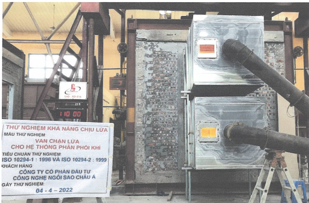
Ảnh D.16: Mẫu thử tại phút thứ 110 của quá trình thử nghiệm
