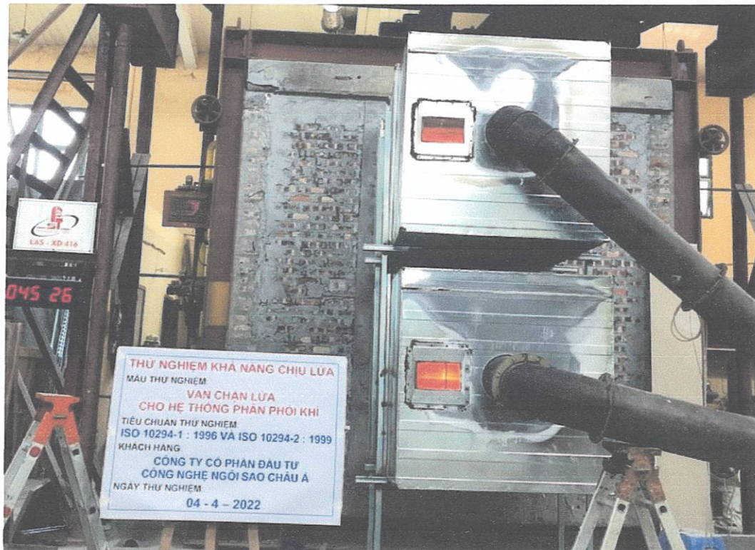
Ảnh D.9: Mẫu thử tại phút thứ 46 của quá trình thử nghiệm
