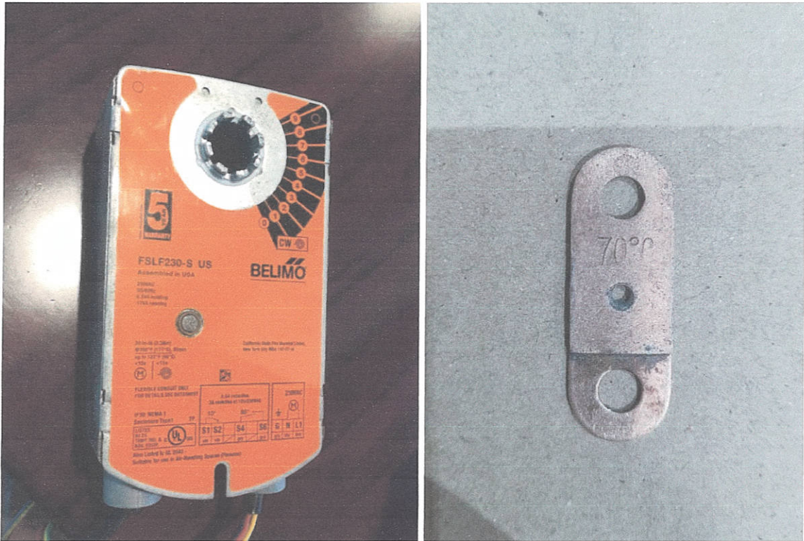
Ảnh D.3: Thông tin cơ cấu kích hoạt của hệ mẫu thử nghiệm
