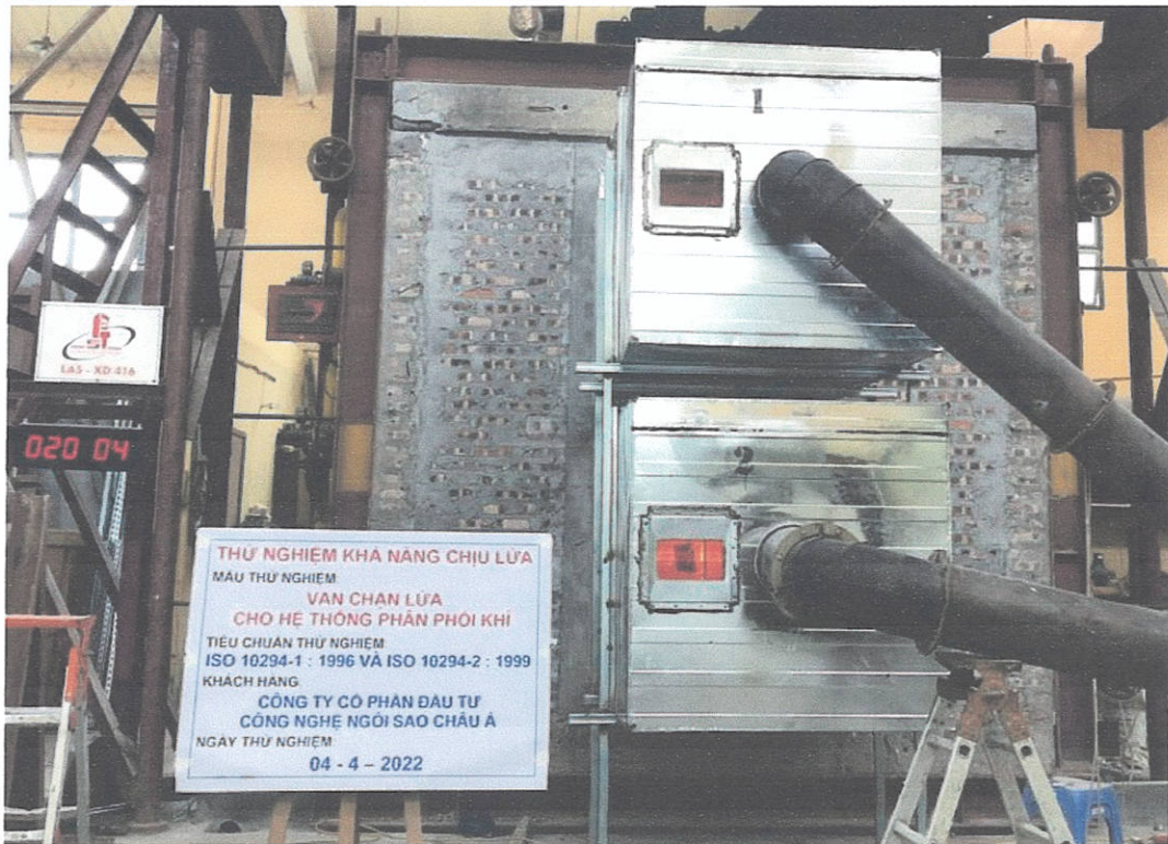
Ảnh D.7: Mẫu thử tại phút thứ 21 của quá trình thử nghiệm
