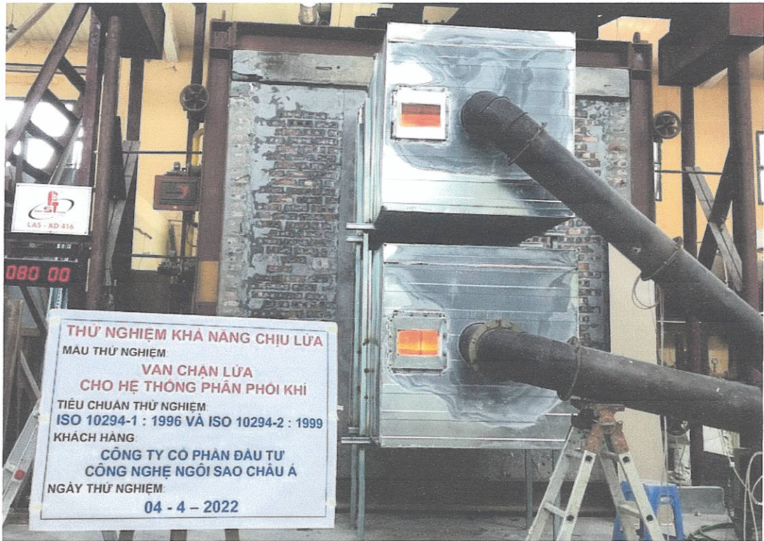
Ảnh D.13: Mẫu thử tại phút thứ 80 của quá trình thử nghiệm
