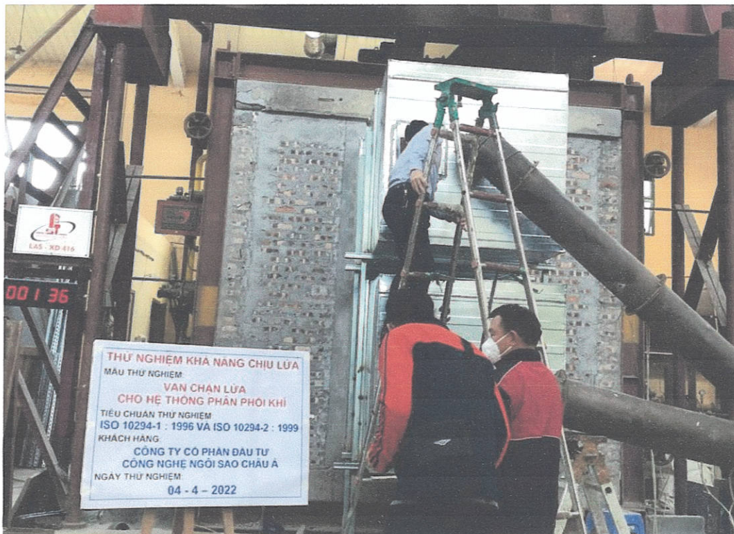
Ảnh D.4: Mẫu thử tại phút thứ 2 của quá trình thử nghiệm
