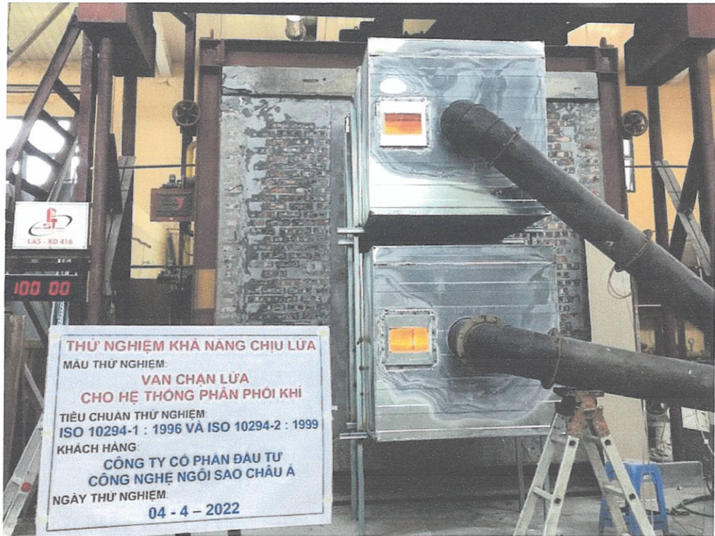
Ảnh D.15: Mẫu thử tại phút thứ 100 của quá trình thử nghiệm
